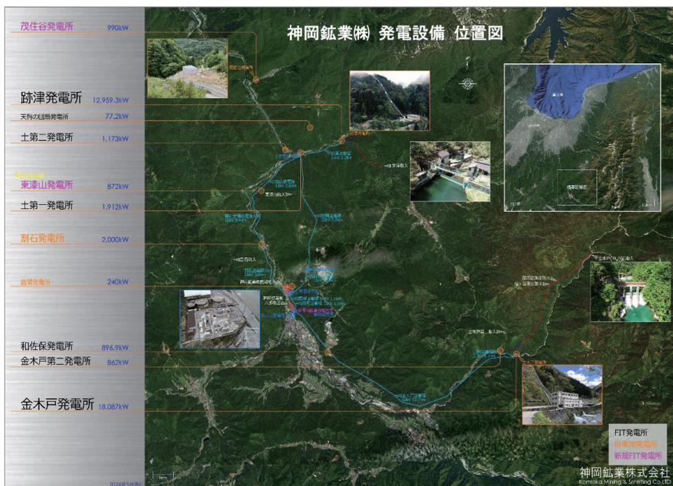
水力発電所は、半径 20 km 圏内に計 11 カ所点在。主に高原川水系の支流から取水している。
