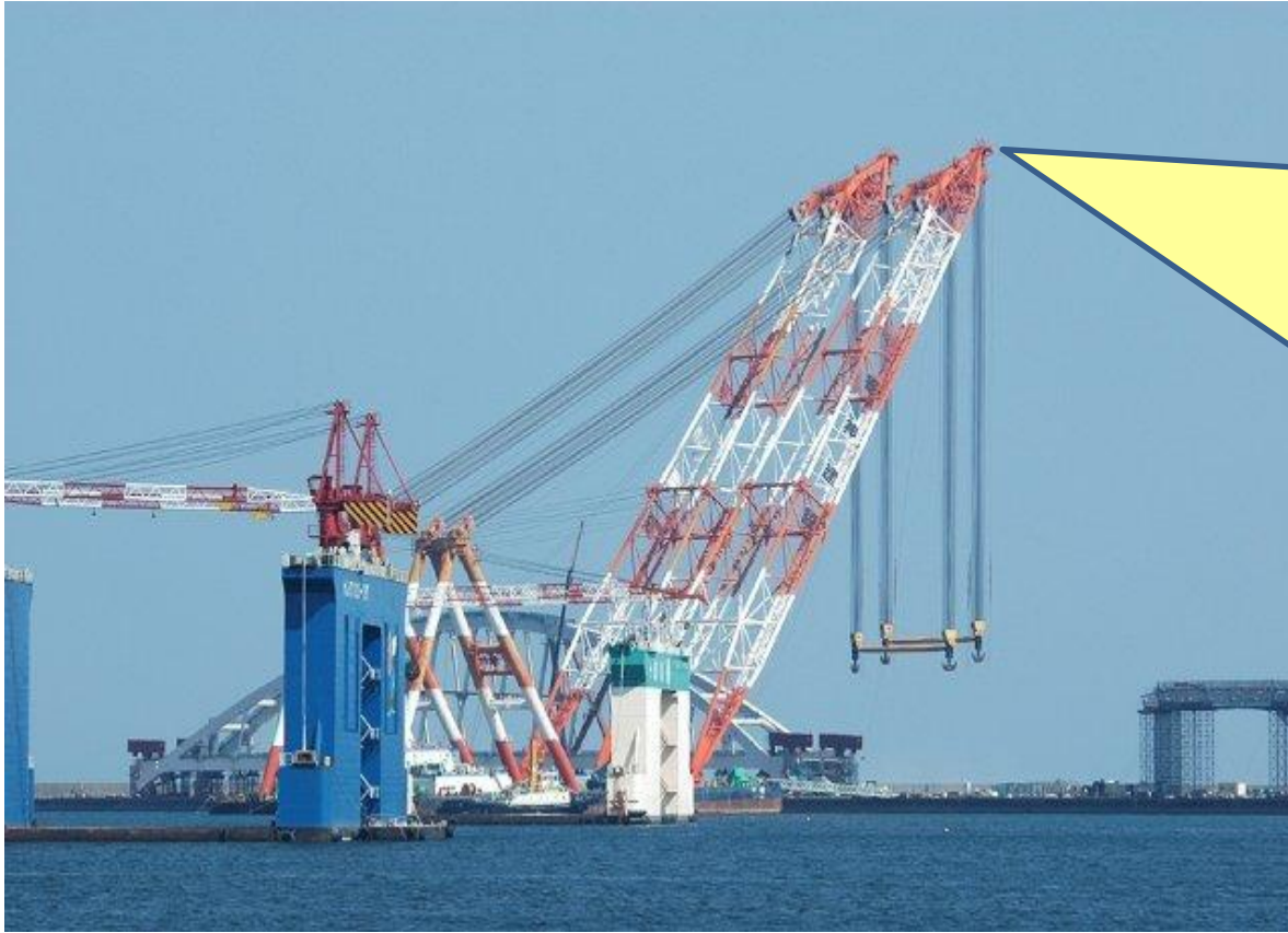
フローティング・クレーン
